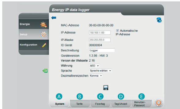
Mit dieser Funktion können Sie einige nutzungsrelevante Parameter für Energy IP data logger einrichten.
