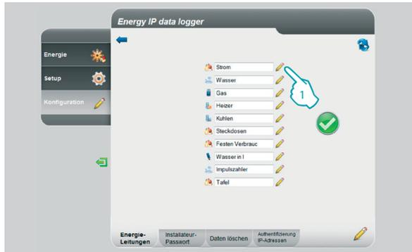
In dieser Seite können Sie die Leitungen der Anlage konfigurieren oder neue im virtuellen Modus erstellen.
