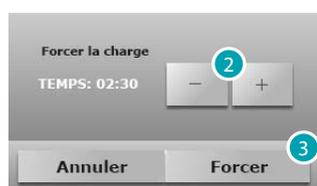
2. Régler le temps de forçage pendant lequel la charge restera momentanément hors du contrôle de la centrale.
