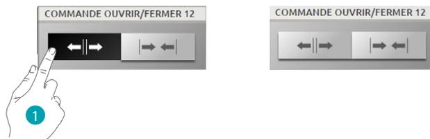
1. Tant que l'icône est enfoncée, l'automatisme s'ouvre, en la relâchant, il s'arrête.
