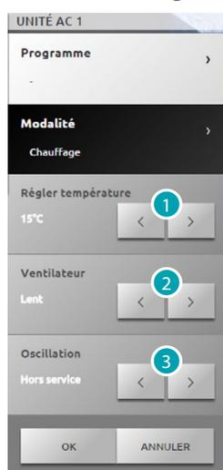
1. Appuyer pour sélectionner la température comprise sur l'intervalle programmé avec le logiciel.
