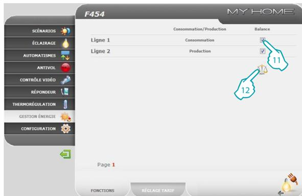
Cette page permet par ailleurs de comparer deux mesureurs pour visualiser la balance entre la consommation et la production d'énergie de l'installation.
