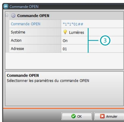
3. Définir automatiquement la commande à bloquer, en la sélectionnant sur la page prévue à cet effet: le système (Scénarios, Lumières ou Automation), l'action (varie en fonction du système) et [l'adresse SCS](#).
