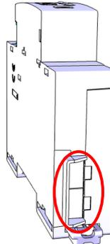
par rails communicants (réfs SXAR18/24/36) pour une connexion arrière via des connecteurs dédiés.
