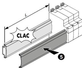
Clipser le cache plastique sur les parties non utilisées du rail communicant
