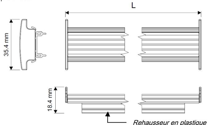
Sans le "rehausseur" pour montage sur rails DIN 7,5 mm de profondeur (**Note** : réf. SXR18 non équipée du rehausseur car non utile pour ce type de rail DIN)
