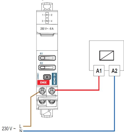
**Note** : quelle que soit la configuration donnée au Module de commande multifonction Nemo SX, il est toujours possible de piloter en local le module de commande via les 2 boutons en face avant du Module.
