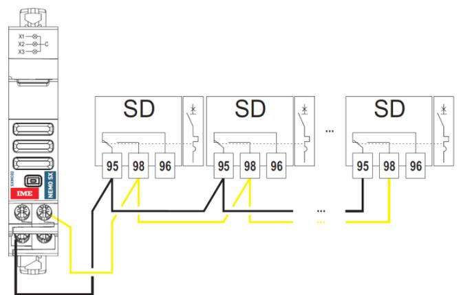
. Association avec un auxiliaire électromécanique des Contacteur ou Télérupteur.
