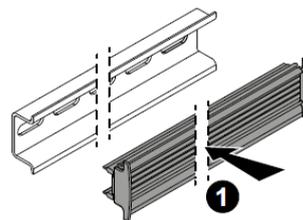
1. Clipser le rail communicant sur le rail DIN
