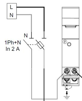
**Note:** Lorsqu'il y a plusieurs modules d'alimentation dans un système, seul un doit être relié à la terre
