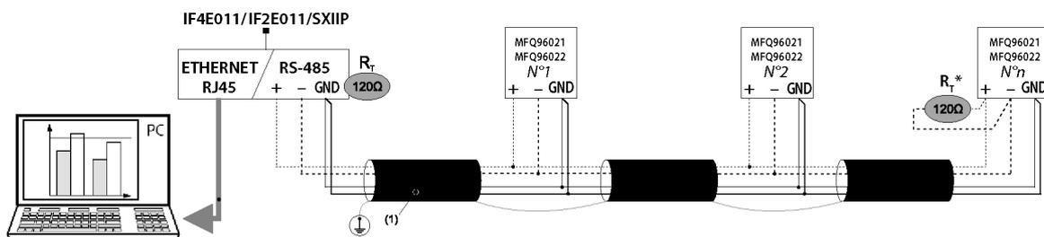
(1) RS485: Utilisation prévue du Câble Belden 9842, Belden 3106A (ou équivalent) pour une longueur maximale du bus de 1000 m, ou du Câble Catégorie 6 cable (FTP ou UTP) pour une longueur maximale de 50 m;
