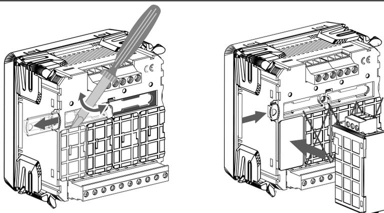
**Note:** Les modules doivent être insérés dans le NEMO 96 EA (non alimenté).
