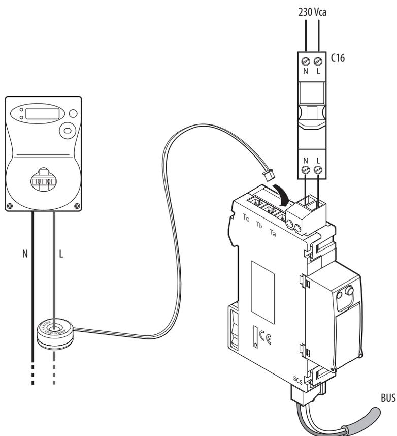
NOTE : Le tore doit être installé avec la partie marquée du code du produit orientée vers le compteur.
