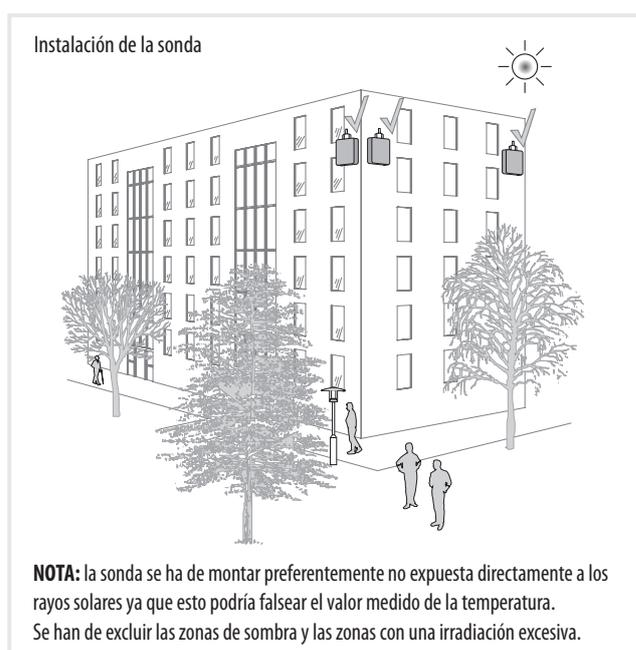
**NOTA:** la sonda se ha de montar preferentemente no expuesta directamente a los rayos solares ya que esto podría falsear el valor medido de la temperatura. Se han de excluir las zonas de sombra y las zonas con una irradiación excesiva.
