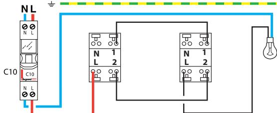
**Αντικατάσταση ενός διακόπτη αλλέ-ρετούρ με έναν συνδεδεμένο ενσύρματο + ένα ασύρματο διακόπτη φωτισμού**
