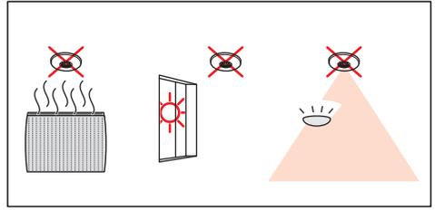
• Éviter les flux d'air direct sur les aérations des produits. Placer le détecteur à une distance supérieure à 1,5m d'une paroi vitrée afin d'éviter la réflexion de l'infra-rouge.
