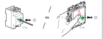
Para concluir a sua instalação, pressione brevemente o botão de configuração na **Gateway modular** ou no centro do **comando geral entrar/sair** sem fios.
