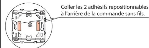
**⚠** Avant de fixer la commande sans fils à l'aide des adhésifs repositionnables fournis, faites un test de collage sur une zone non visible du mur.
