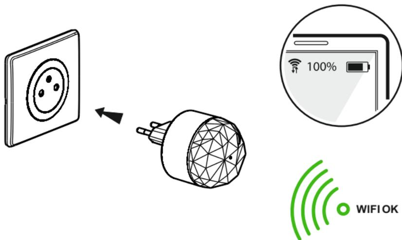
Vérifier avec un smartphone que le niveau de signal Wifi est suffisant près de la prise de courant où sera branché la Prise Control mobile.
