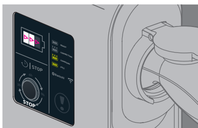
„Ladestation mit dem Fahrzeug verbunden“, wartet auf Laden (weißes Lauflicht) (0 bis 30 Sek. je nach Fahrzeug) „Oplaadstation is verbonden met het voertuig“ in afwachting van het oplaadproces (wit scrollend) (0 tot 30 sec, afhankelijk van het voertuig)
