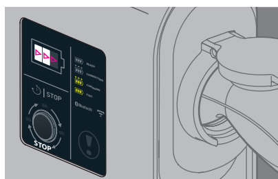
"Borne conectada al vehículo" a la espera de carga (desplazamiento en blanco) (de 0 a 30" según el vehículo) "Posto de carga ligado ao veículo" a aguardar carga (branco em deslocamento) (0 a 30 segundos, dependendo do veículo)
