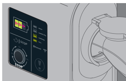
"Carga del vehículo" (desplazamiento en verde) "Veículo a carregar" (verde em deslocamento)
