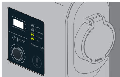
„Spannungsführende Ladestation“ (konstant weißes Leuchten) „Oplaadstation onder spanning“ (constant wit)
