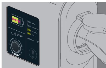
Fin del tiempo programado "Carga del vehículo" (desplazamiento en verde) Pilotos "3 h/6 h/9 h" apagados Fim do tempo programado "Veículo a carregar" (verde em deslocamento) Indicadores "3h/6h/9h" apagados
