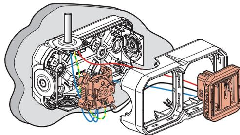
2 Instalar la toma de corriente y el módulo conectado
