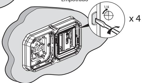
2 Instalar la toma de corriente y el módulo conectado
