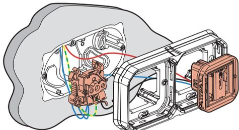
4 Instalar la toma de corriente y el módulo conectado en la caja o en el soporte empotrado
