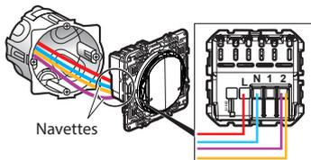
Ancien interrupteur encastré remplacé par la commande sans fils.
