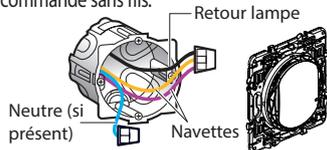
Utiliser un connecteur pour raccorder ensemble les 3 fils (retour de lampes, navettes).
