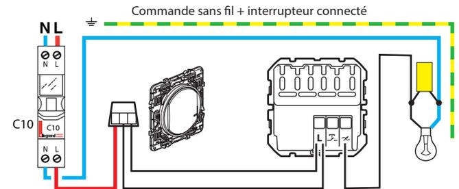
Utilisez un **connecteur** pour raccorder ensemble les 3 fils (navettes 1, 2 et retour de lampe).
