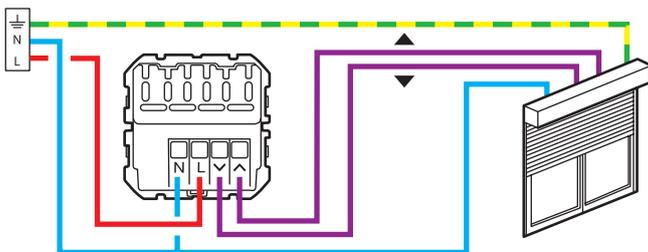
L'interrupteur connecté pour volet roulant with Netatmo est compatible avec les volets roulants à butée mécanique ou électronique, contrôlés par un interrupteur filaire classique pour volet roulant. Ils ne sont pas compatibles avec les moteurs contrôlés directement par une commande radio.
