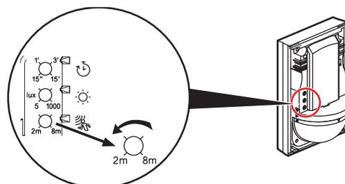
Pour réduire la sensibilité du détecteur de mouvement, tournez la vis (potentiomètre) dans le sens inverse des aiguilles d'une montre. La détection se fera alors à une distance plus courte.
