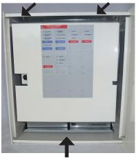
Engager le capot dans les encoches en haut du socle et la vis en bas du socle.
