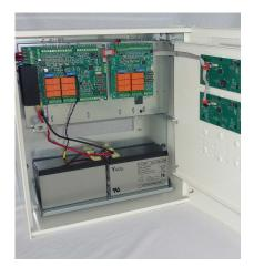
Fixer le DCS au mur, avec la plaque plastique. Effectuer le raccordement en passant les câbles dans les zones réservées. Attacher les câbles avec des colliers Colring.
