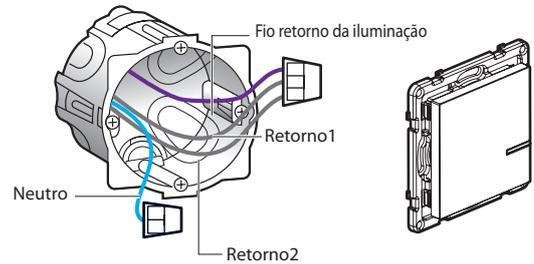
Use um conector de junção para os 3 fios (retorno 1 e 2 e retorno da lâmpada). Use um outro conector para fio neutro.
