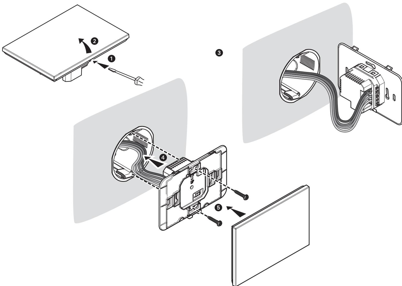
**Attention:** éviter de serrer excessivement les vis pour prévenir les déformations de la base susceptibles de compromettre la bonne installation du dispositif. La partie frontale doit être solidement fixée à la base et le ressort de fixation doit s'engager dans la position prévue à cet effet. Une fois l'installation terminée, attendre 2 heures avant de contrôler la température mesurée.
