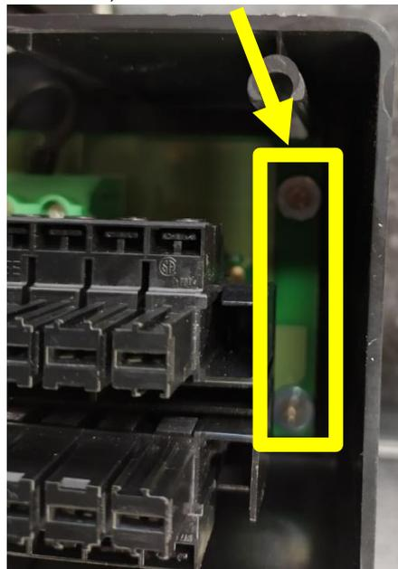
9) Ricollegare il connettore EC2 e rimontare il bypass
