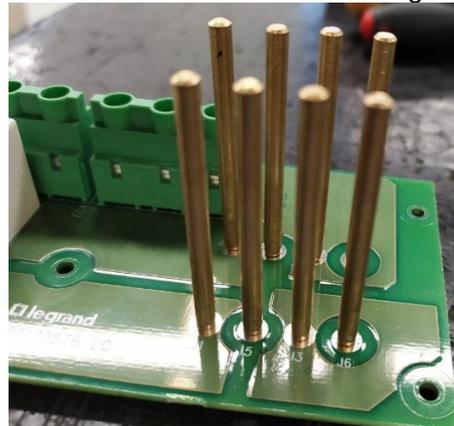
7) Inserire i supporti in dotazione nella busta accessori del bypass nelle colonne della scheda. Inserire e avvitare i connettori in dotazione nella busta accessori del bypass.
