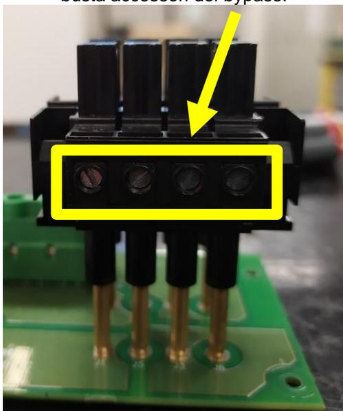
8) Alloggiare nuovamente la scheda bypass nel contenitore, avvitando le viti con rondella
