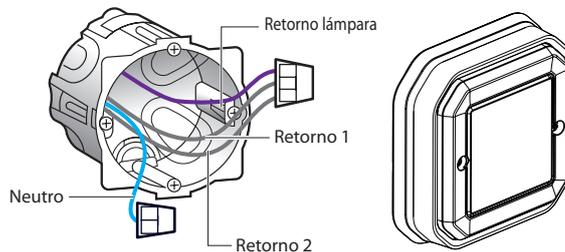
Utiliza un **conector** para conectar los 3 cables juntos (retorno de lámpara, retorno 1 y 2).
