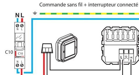
Utilisez un connecteur pour raccorder ensemble les 3 fils (navettes 1, 2 et retour de lampe).
