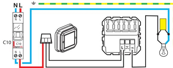
Usar un conector para conectar los 3 hilos juntos (retorno 1 y 2 y retorno lámpara).
