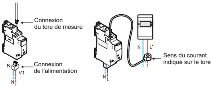
Un disjoncteur de protection du Délesteur connecté est nécessaire
