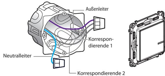
Verwenden Sie eine **Verbindungsklemme** um die 3 Drähte zu verbinden (die 2 Korrespondierenden und die Lampenleitung). Verwenden Sie eine zweite Klemme für einen eventuell vorhandenen Neutralleiter.
