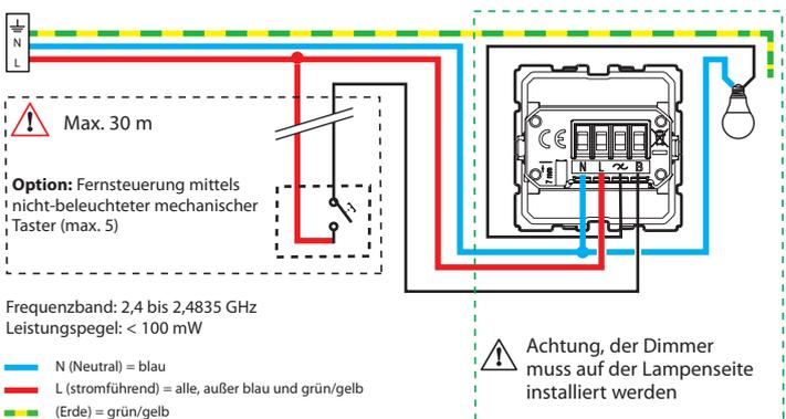
Der vernetzte Schalter (mit Dimmer-Option) ist kompatibel mit Standardlampen oder dimmbaren Leuchten, einschließlich LEDs. Dimmbare LEDs sind für den optimalen Betrieb zwingend erforderlich.
