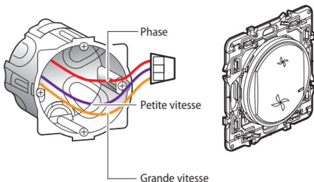
Utilisez un **connecteur** pour raccorder ensemble les 3 fils (petite vitesse, grande vitesse et phase).
