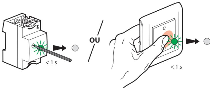
Pour terminer votre installation, appuyez brièvement sur le bouton de configuration du **Module Control** ou au centre de la **Commande générale sans fil Départ/Arrivée**.
