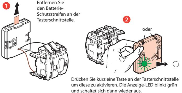
Installieren Sie die Tasterschnittstelle noch nicht im Aufputzgehäuse. Dies wird in den Schritten 6 & 7 durchgeführt.
