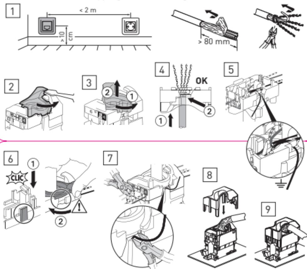
**Dans le cadre d'un ajout d'une prise RJ45, conserver le type de câblage initial.**
