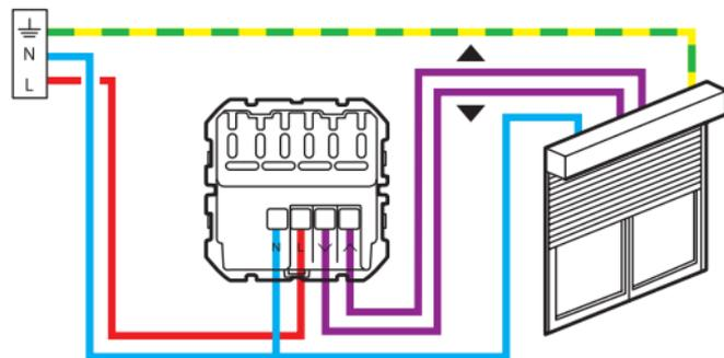
L'interrupteur pour volet roulant est compatible avec les volets roulants à butée mécanique ou électronique, contrôlés par un
