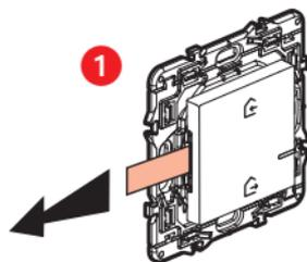
Retirez la languette de protection de la pile pour alimenter la **commande générale sans fil**.
