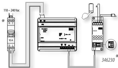
18V 4A Stoßstrom; 250mA Haltestrom (30 Ohm max).
