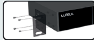
Installez les équerres pour le montage en baie/coffret 19"
