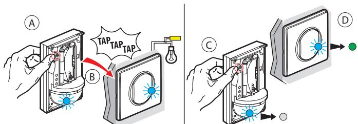
Шаг А: Удерживая нажатой кнопку ON умного беспроводного датчика движения, постучите 3 раза датчиком по умному проводному выключателю, которым вы хотите управлять.
