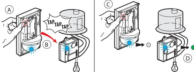
Шаг А: Удерживая нажатой кнопку ON умного беспроводного датчика движения, постучите 3 раза датчиком по умному розетке, которой вы хотите управлять.
