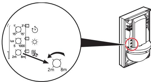
Для уменьшения чувствительности датчика, поверните потенциометр против часовой стрелки. Полоса действия датчика уменьшится.
