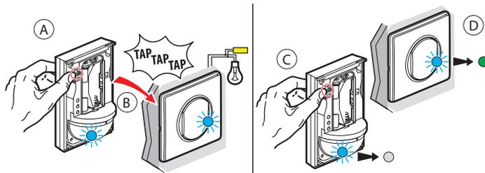
Etapa A : Mantener presionado el botón ON del detector de movimiento inalámbrico mientras se hace «taptaptap» 3 veces con el detector sobre el interruptor que se quiere controlar.
