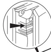
Presionar el botón ON u OFF del detector de movimiento para verificar que la iluminación se enciende o apaga. Si el estado de la iluminación no cambia, dirigirse al inicio de la etapa 4.2.1.
