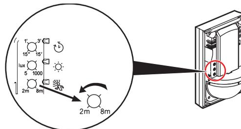
Para reduzir a sensibilidade do detetor de movimento, gire o parafuso (potenciômetro) no sentido anti-horário. A detecção será então a uma distância menor.
