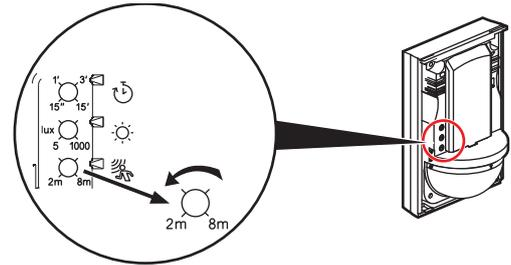
Para reducir la sensibilidad del detector de movimiento, gire el tornillo (potenciómetro) en sentido antihorario. La detección se realizará a una distancia más corta.
