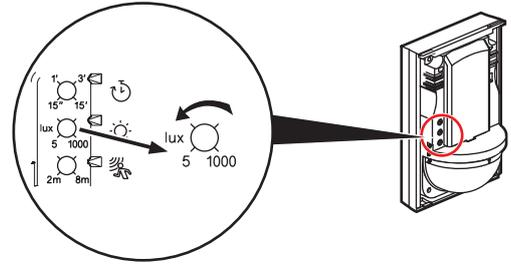
Para que el detector se active sólo cuando oscurezca, gire el tornillo (potenciómetro) en sentido antihorario.
