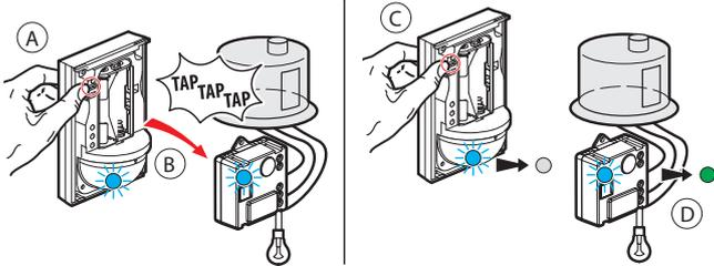
Etapa A : Mantener presionado el botón ON del detector de movimiento inalámbrico mientras se hace «taptaptap» 3 veces con el detector sobre el micromódulo que se quiere controlar.
