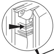
Presionar el botón ON u OFF del detector de movimiento para verificar que la iluminación se enciende o apaga. Si el estado de la iluminación no cambia, dirigirse al inicio de la etapa 4.1.1.
