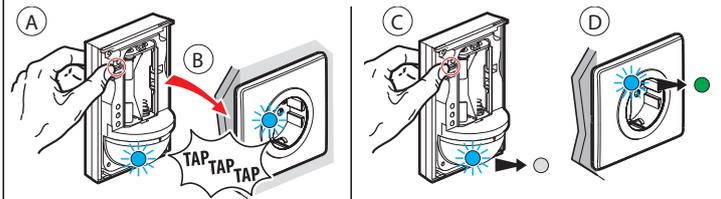
Etapa A : Mantener presionado el botón ON del detector de movimiento inalámbrico mientras se hace «taptaptap» 3 veces con el detector sobre la base de corriente que se quiere controlar.
