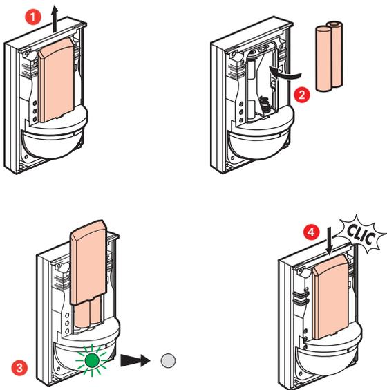
El detector de movimiento parpadea en verde y posteriormente se apaga. El producto está listo para ser configurado.
