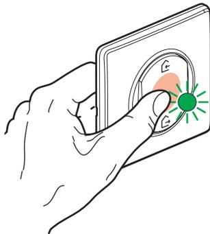
Para terminar la instalación presionar brevemente en el centro del comando general inalámbrico **Entrar/Salir**.
