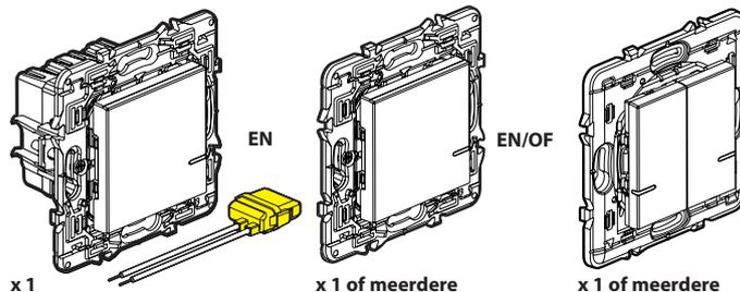
Geconnecteerde schakelaar (met dimmeroptie) + compensator
