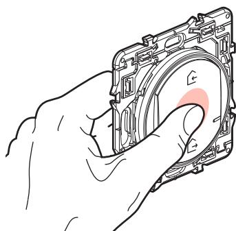
Για να ολοκληρώσετε την εγκατάσταση, πιέστε σύντομα στο κέντρο του πλήκτρου του γενικού ασύρματου διακόπτη master Αναχώρησης/Αφίξης
