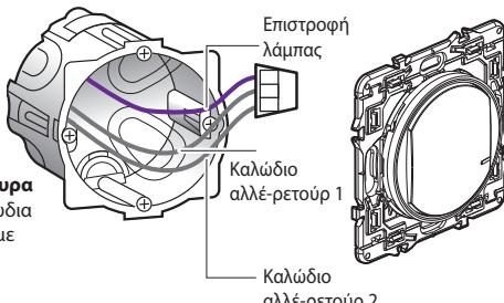
Χρησιμοποιήστε μία **γέφυρα** για να συνδέσετε τα καλώδια του αλλέ-ρετούρ 1 και 2 με αυτή της επιστροφής της λάμπας.
