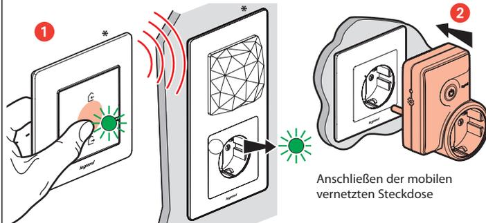
Drücken Sie die Tastenmitte des drahtlosen **Master-Switch** bis die LED-Anzeige grün leuchtet, danach lassen Sie die Taste los und die Anzeige erlischt
