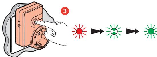
Die LED-Anzeige an der EIN/AUS-Taste der **mobilen vernetzten Steckdose** leuchtet rot auf. Drücken Sie die Taste bis die Anzeige grün blinkt, dann warten Sie bis diese durchgehend grün leuchtet: die Konfiguration wurde erfolgreich durchgeführt.
