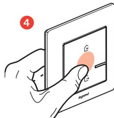
Zum Abschließen der Installation **drücken Sie kurz** auf den **Master-Switch**. Die LED-Anzeige an der mobilen vernetzten Steckdose erlischt. Öffnen Sie die **Legrand-App Home + Control** und folgen Sie den Anweisungen.
