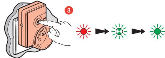
Le voyant du bouton interrupteur ON/OFF de la **prise mobile connectée** s'allume en rouge au démarrage. Appuyez sur le bouton jusqu'à ce que le voyant clignote en vert, attendre que le voyant s'allume en vert fixe indiquant que la configuration est terminée.
