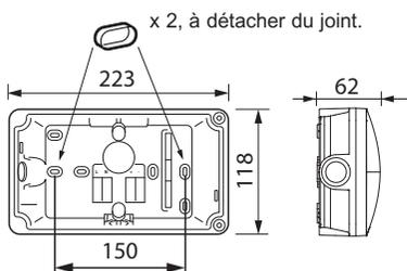
Mettre en place les bouchons ainsi que le presse étoupe pour assurer l'étanchéité du bloc (IP66).
