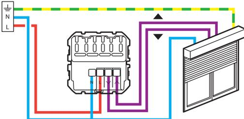
Der Rollladenschalter ist kompatibel mit Rollläden die einen mechanischen oder elektronischen Endlagenschalter besitzen und durch einen Standard-Rollladenschalter gesteuert werden.
