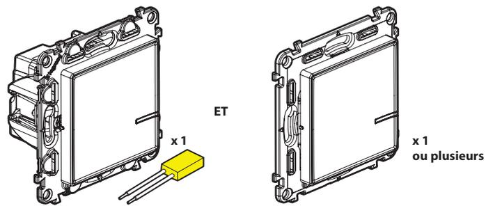
Interrupteur d'éclairage + compensateur (inclus dans ce pack) ET x 1 ou plusieurs
