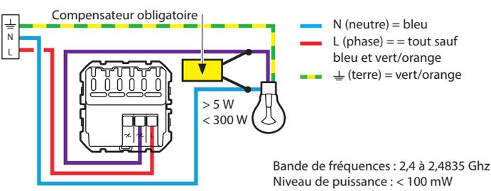
Pour le bon fonctionnement de votre interrupteur, il est **obligatoire** de câbler le **compensateur** fourni au plus près de la charge et de mettre **une ampoule** avant la mise sous tension.
