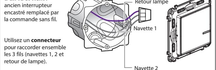
Utilisez un connecteur pour raccorder ensemble les 3 fils (navettes 1, 2 et retour de lampe).
